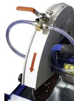
Rozvod chladicí vody na krytu
