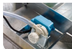
Čerpadlo chladicí vody
