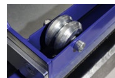
Zatěsněné kladky pojezdu stolu
